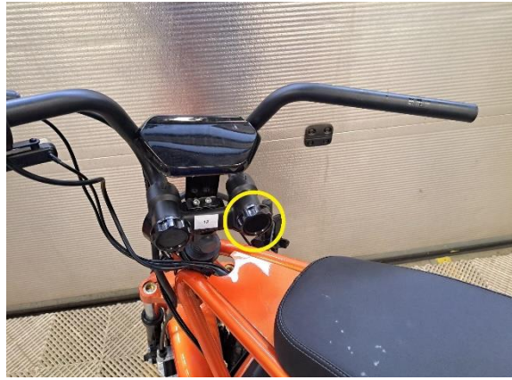
Irrota oikeanpuolen ohjaustangon kiinnike pyörittämällä vastapäivään.
